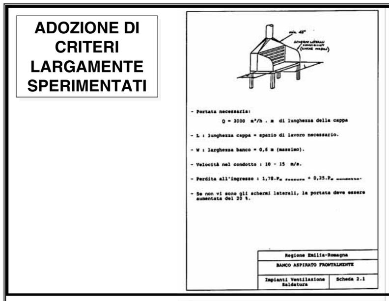
Figura 15: Progettazione di una cappa aspirante mobile
