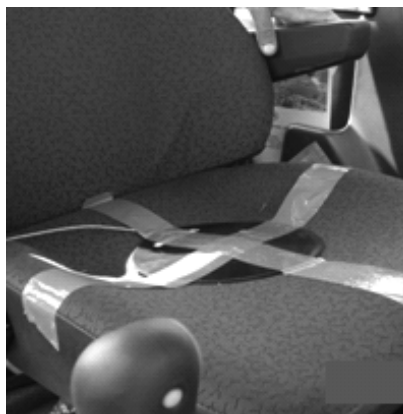
Figura 2 - Accelerometro posto sul sedile del trattore.
