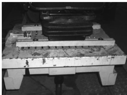
Figura 3 - Banco prova del CNR-IMAMOTER di Torino: accelerometro posto a livello dell'ancoraggio del sedile al banco di prova.
