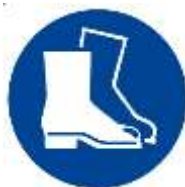
Obbligo di indossare calzature di sicurezza
