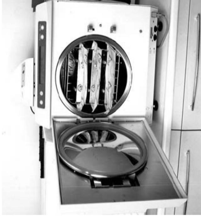
la presenza di aria nella camera di sterilizzazione è un fattore di criticità
