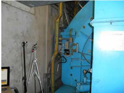
All'interno del cabinato che contiene l'alternatore sono presenti livelli di ultrasuoni  $Leq(G) = 110.8$  dBG.
