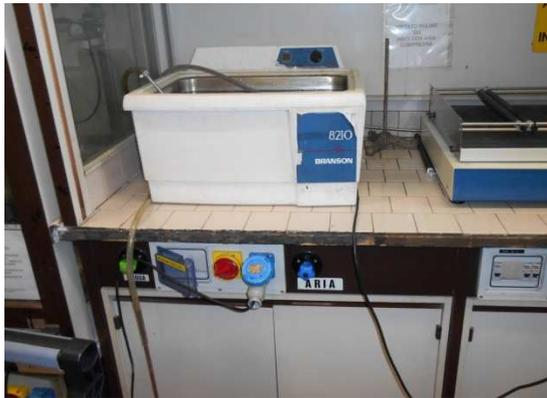
Portante  $f=45\text{kHz}$   $Leq(50\text{kHz}) = 110.9 \text{ dB}$ , valore al di sopra della soglia consentita. L'uso della vasca all'interno di una cappa aspirante, con vetro di protezione, riduce i valori al ricevitore a  $Leq(50\text{kHz}) < 88.6 \text{ dB}$  al di sotto dei valori di attenzione.
