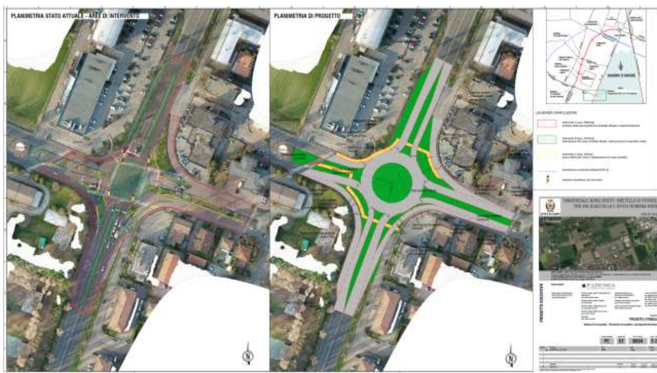
Figura 12 – Progetto rotatoria nell'intersezione Tangenziale Bruno Losi/Via Guastalla
