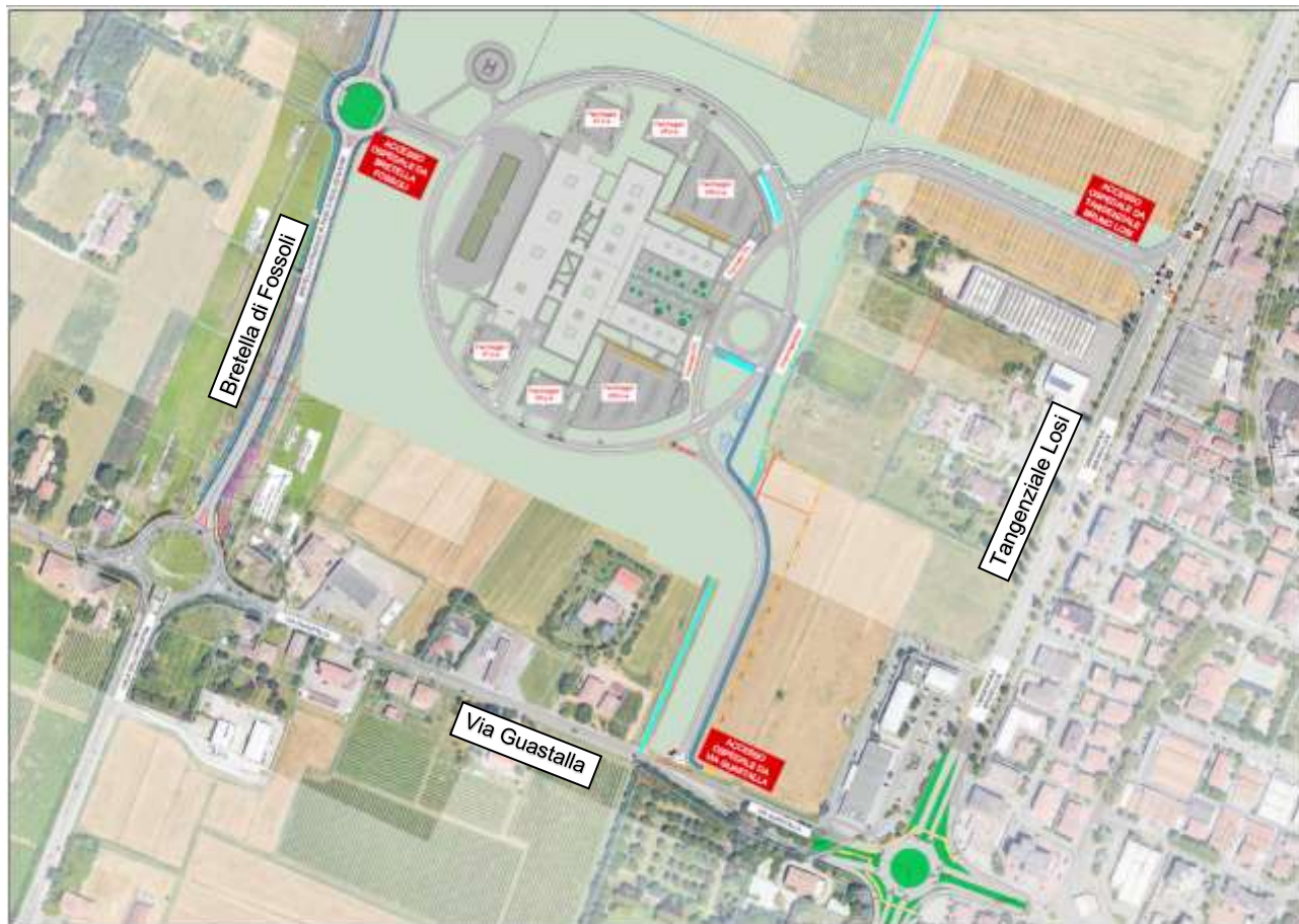
Figura 22. Planimetria generale del progetto – Accessi all'area ospedaliera
