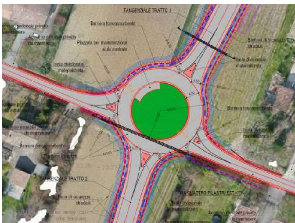
Figura 14. Estratto planimetria di progetto rotatoria Via Quattro Pilastri/Bretella di Fossoli
