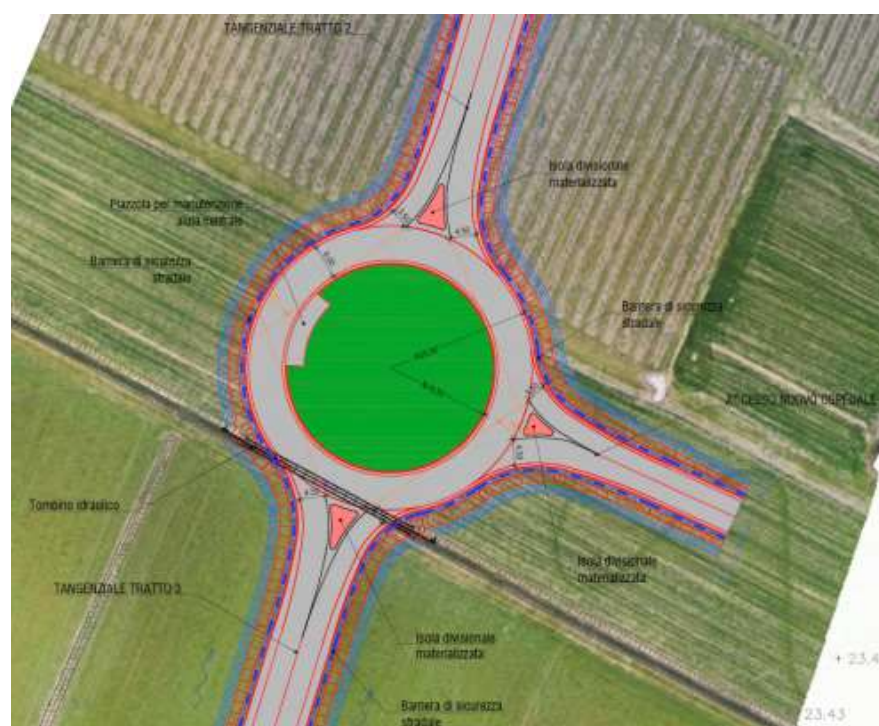
Figura 15. Estratto planimetria di progetto rotatoria accesso nuovo Ospedale
