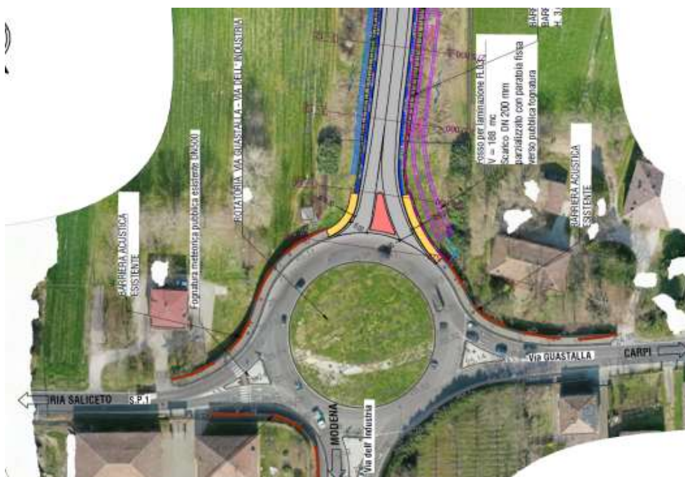
Figura 49. Estratto planimetria di progetto rotatoria Via dell'Industria/Via Guastalla
