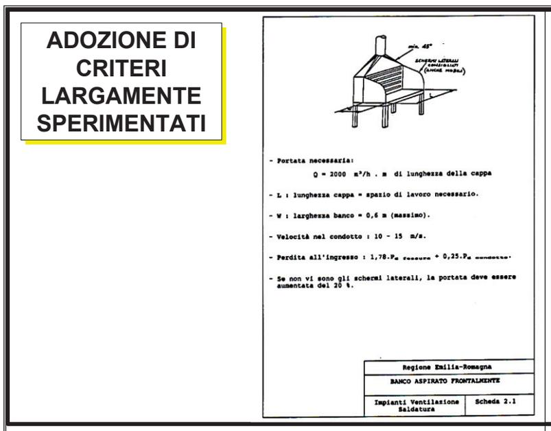
Figura 14: Progettazione di una cappa aspirante mobile
