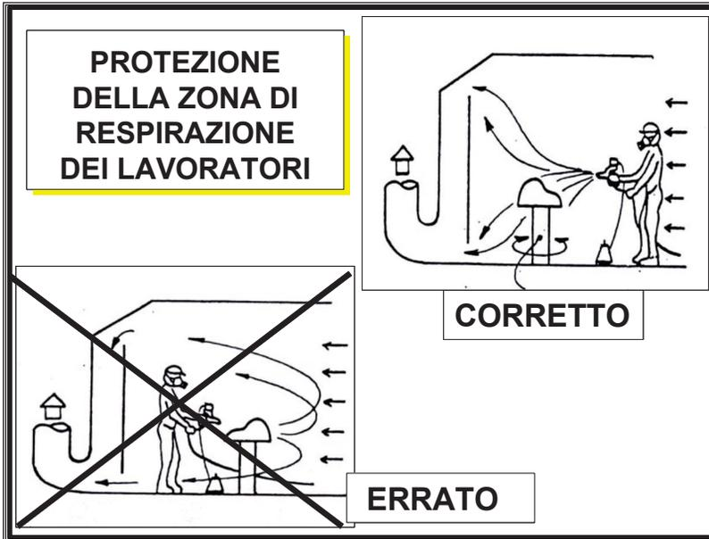
**Figura 9:** L'importanza della collocazione funzionale di una cappa
