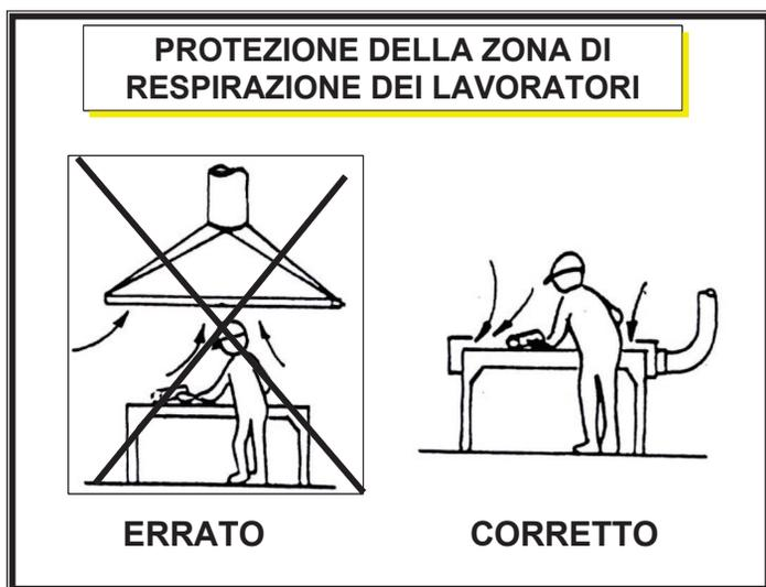
**Figura 8:** Esempio di lavorazione praticata in maniera non corretta e corretta
