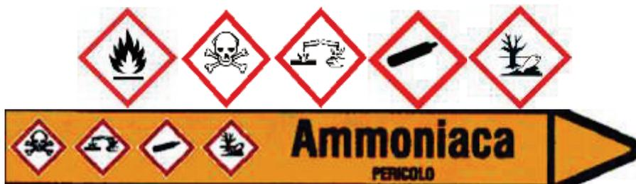
**Figura 3:** Sistemi visibili di segnalazione delle tubazioni
