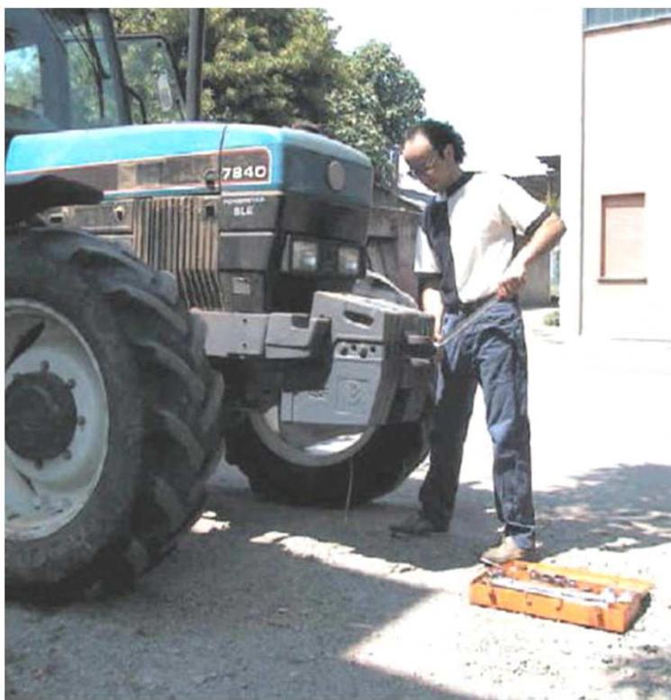
La trattrice va sottoposta a idonea manutenzione, con controlli periodici dei dispositivi di protezione e dei vari elementi della macchina (es. telaio, cinture, freni, presa di forza...). Generalmente la frequenza dei controlli è biennale o ogni 1000 ore di utilizzo.
