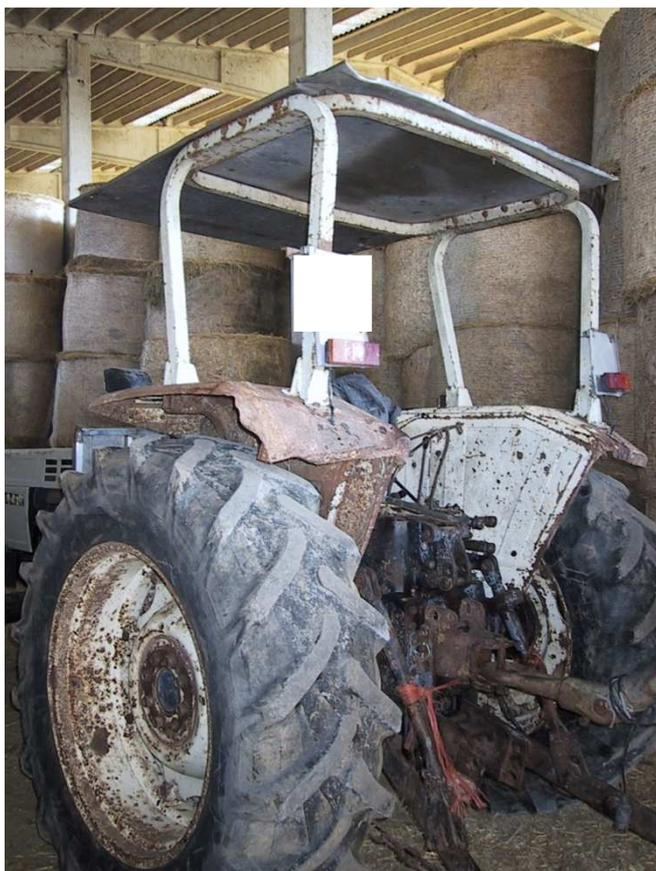
I componenti del telaio/arco di protezione del posto di guida (tubolari, piastre, flange, giunti saldati, viti e bulloni), nel tempo si possono usurare.
