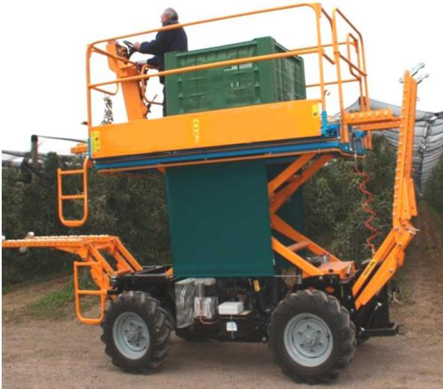
Il meccanismo di sollevamento del carro (pantografo) deve essere protetto contro il pericolo di cesoiamento mediante teli laterali avvolgibili che evitino il contatto accidentale. Deve essere presente un limitatore di velocità del carro.
