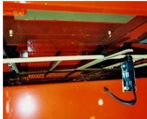
La parte sottostante la piattaforma mobile deve essere protetta mediante griglia sensibile collegata a microinterruttore
