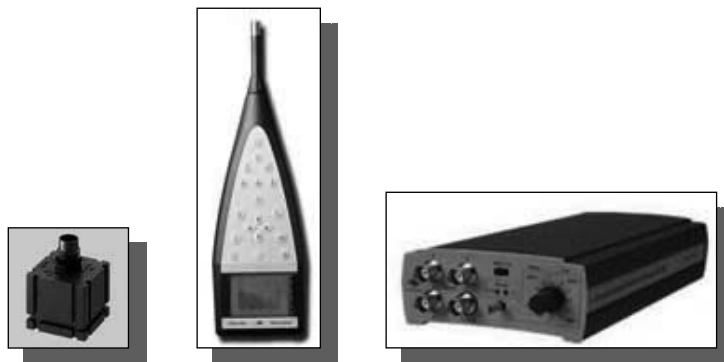
Figura 1: Accelerometro triassiale Brüel & Kjær Deltatron® 4506; interfaccia a 3 canali per vibrazioni umane Brüel & Kjær 1700; fonometro integratore Brüel & Kjær Investigator 2260.
