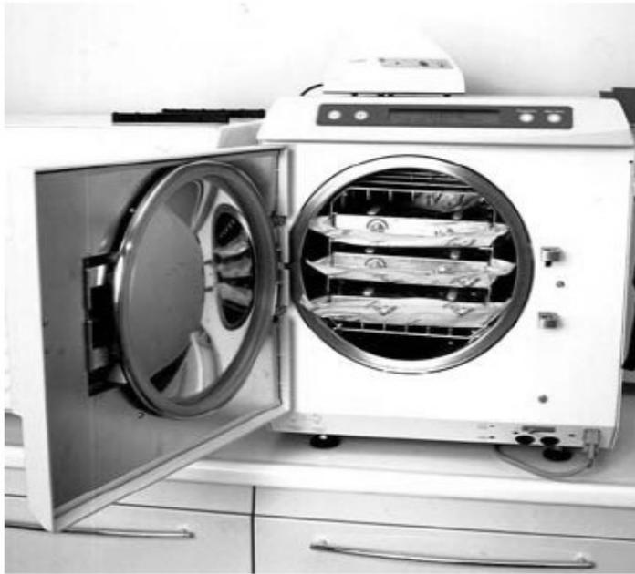
la presenza di aria nella camera di sterilizzazione è un fattore di criticità
