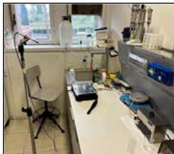
**Figura 6** – bagno ad ultrasuoni in funzione con microfono di misura
