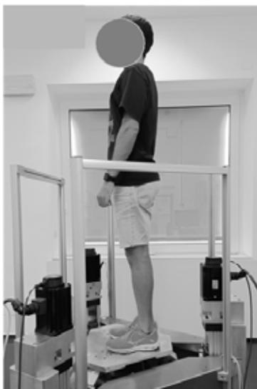
**Figura 1. Soggetto esposto a vibrazione trasmessa attraverso i piedi in condizioni di laboratorio.**
