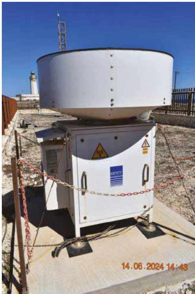
Figura 1. Radar meteorologico MIRA-35C installato nella Stazione di osservazioni climatiche dell'ENEA nell'isola di Lampedusa.
