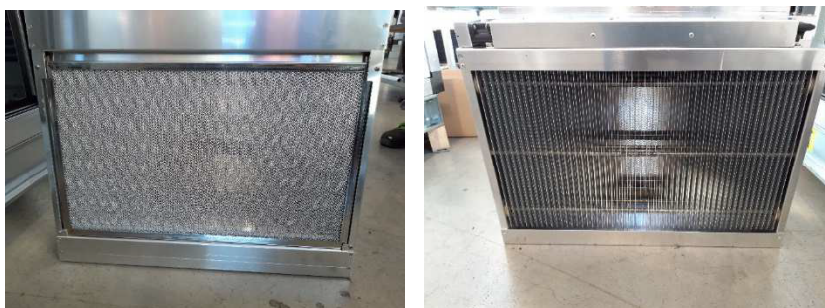
Fig. 32 - A sinistra il lato aspirazione del filtro elettrostatico protetto tra un prefiltro metallico. A destra il lato di mandata del filtro nel quale è possibile osservare le piastre metalliche tra cui viene stabilito il campo elettrico responsabile del processo di filtrazione.
