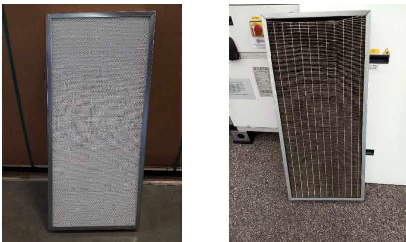
Fig. 31 - A sinistra un filtro F7 nuovo. A destra lo stesso filtro dopo due mesi di funzionamento.
