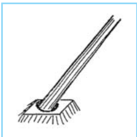
POSA DI UN PILONE NEL SUO BASAMENTO. SARA' SUCCESSIVAMENTE ERETTO E CEMENTATO
