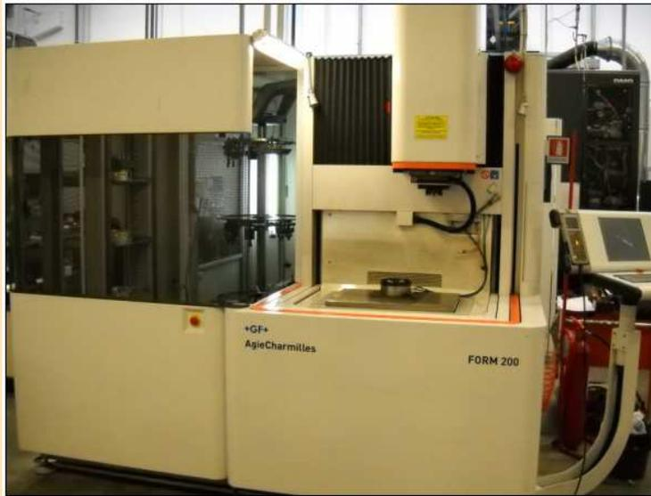
*Macchina per elettro-erosione a tuffo*
