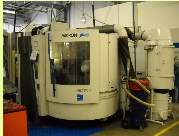
*Fresatrice automatica a controllo numerico a 5 assi con filtro per abbattimento polveri di grafite*
