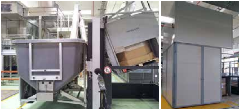
Figura 4: posizionamento della barriera in prossimità della macchina
