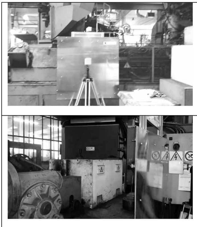
**Tab.L – Forni ad induzione analizzati – collaudo schermatura (in alto forno ID  $\alpha$ , in basso ID  $\beta$ )**
