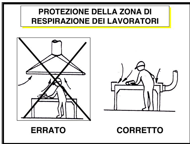
Figura 8: Esempio di lavorazione praticata in maniera non corretta e corretta
