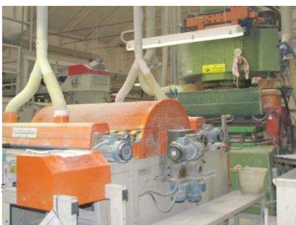
Aspirazione delle polveri dopo pulitura delle piastrelle.
