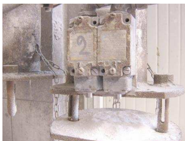
Particolari: gli agganci per lo scarico pneumatico e il microcontatto del circuito di controllo.
