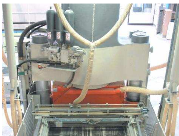
Aspirazione delle polveri sulla traversa posteriore mobile e su tramogge laterali di caricamento
