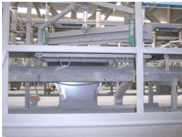
Coltelli deviatori e aspirazioni localizzate
