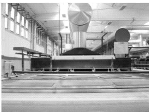
Ridotto "spolvero" di engobio in uscita forno (gres porcellanato).
