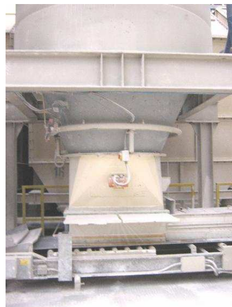
A dx.: I sili riforniti dai tubi, alimentano nastri trasportatori
