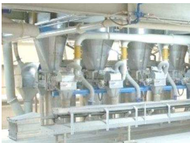
Alimentazione con nastri e condotte, trasporto con nastri chiusi e aspirati. A dx. micronizzatori a pioli.
