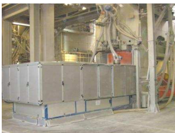
Segregazione della pressa dal lato del caricamento.
