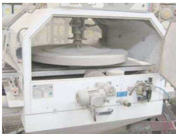
Sopra: Cabina aspirata e spazzolone.
