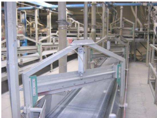
Coltelli deviatori e aspirazioni localizzate
