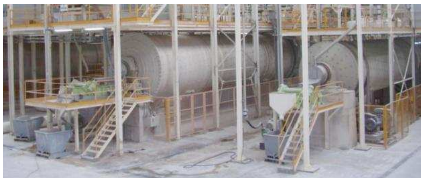
Sopra: batteria di mulini continui con vibrosetacci allo scarico.
