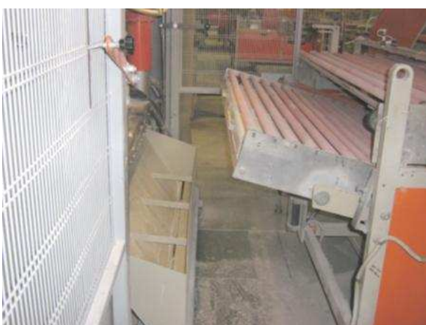
La rulliera mobile all'uscita della pressa, facilita l'accesso per manutenzioni o pulizie.
