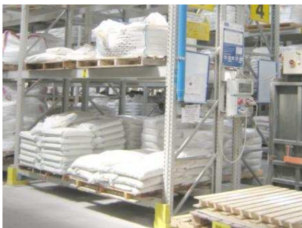
Scaffalatura provvisto di calata (tubo blu) per la pulitura delle polveri.
