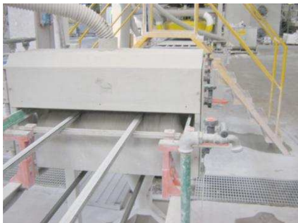
Depolverazione della piastrelle; successivi soffiaggio (con ventola) e contenimento delle polveri tramite carteratura aspirata.
