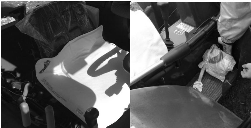
Figura 2: Posizionamento dei sensori capacitivi sul sedile di un trattore gommato (foto a sinistra); posizionamento dei sensori capacitivi sul pedale del freno (foto a destra).
