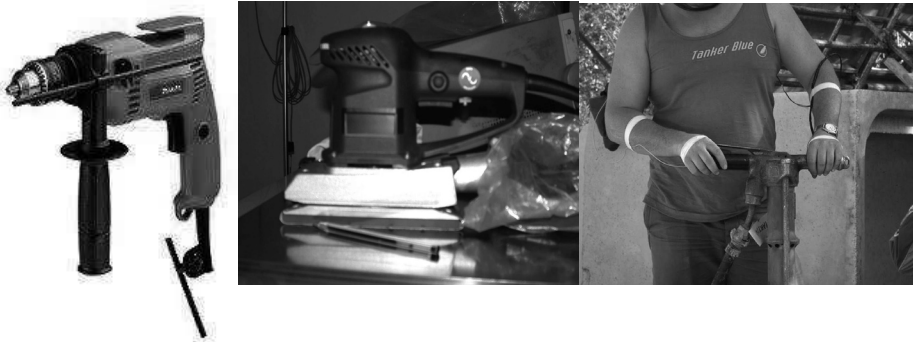
Figura 2: Da sinistra a destra sono raffigurati gli utensili misurati su campo e cioè un trapano Makita, una levigatrice Metabo ed un martello pneumatico TEX 32.
