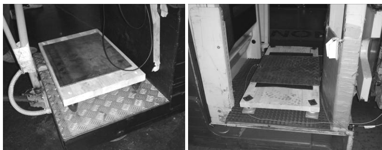
Figura 5: Foto delle due pedane antivibranti (1 a sinistra, 2 a destra) nelle reali condizioni di utilizzo.
