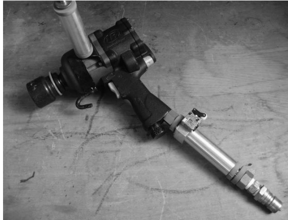
Figura 13: Aspetto finale dell'avvitatore con le due impugnature supplementari disaccoppiate meccanicamente dal corpo utensile.
