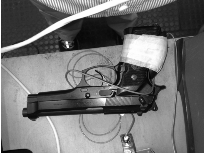
Figura 1: Pistola d'ordinanza Beretta 92 FS, utilizzata dai Carabinieri di Vicenza, strumentata con adattatore palmare contenete l'accelerometro triassiale, sul calcio
