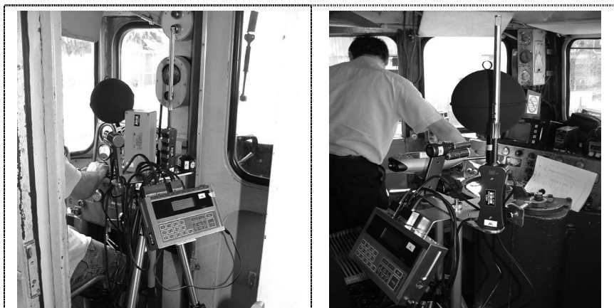
Figura 1: Centralina di acquisizione dati con relative sonde collegate, in alcune postazioni di misura, montati su un cavalletto e supporti.
