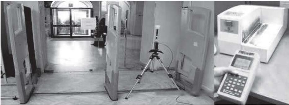
**Fig. 2a** A sinistra misura dell'esposizione nel punto di passaggio di un doppio varco di un sistema antitaccheggio. A destra misura dell'esposizione percentuale a breve distanza da uno smagnetizzatore
