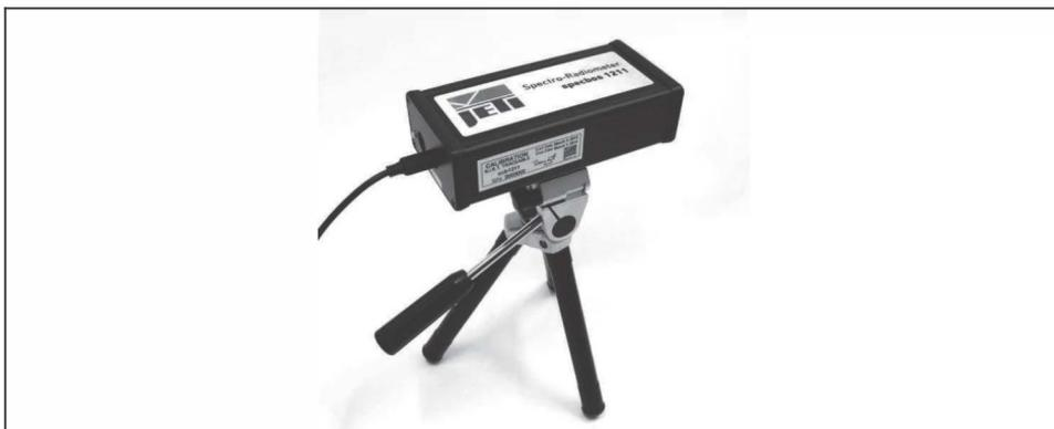
**Figura 9:** Spettrofotometro per misurazioni ambientali
