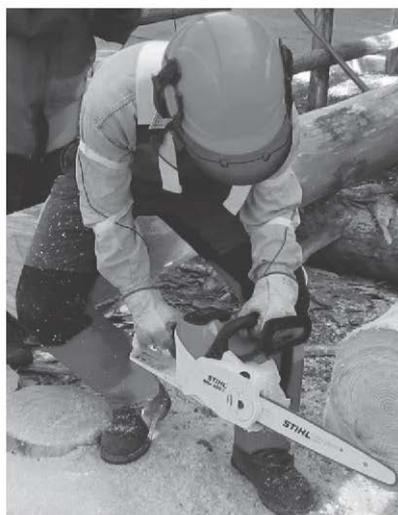
Figura 6: Prova con Svantek: dai guanti da lavoro escono i cavi di collegamento con l'unità di acquisizione, tenuti fermi tramite nastro adesivo.
