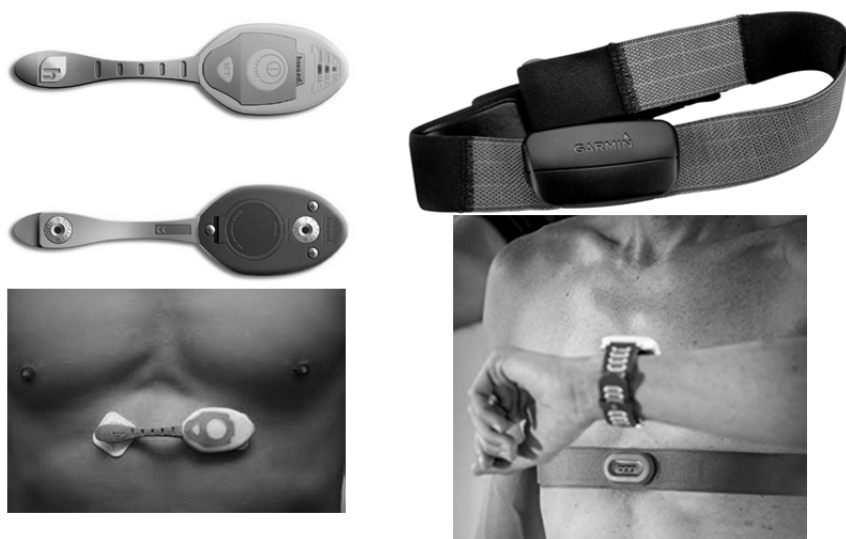
Figura 2. Tipologia di dispositivi per il monitoraggio della frequenza cardiaca da torace da noi valutati per l'adozione in campo.
